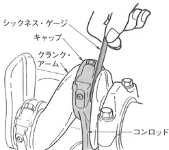
図59. コンロッド大端部側面の摩耗の点検
