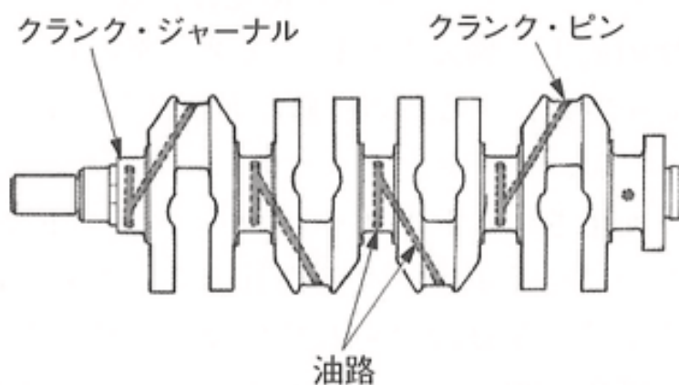
図30. クランクシャフトの油路
