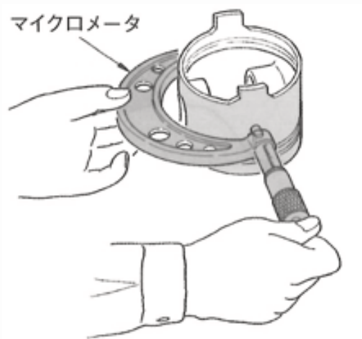
図51. ピストン外径の測定
